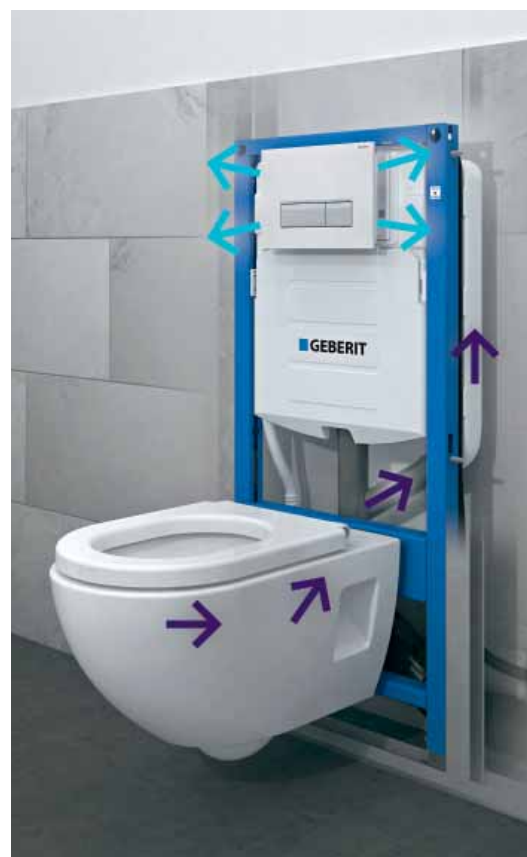
Systém Geberit DuoFresh odsává vzduch přímo ze záchodové mísy a čistí ho pomocí filtru s aktivním uhlím umístěného za ovládacím tlačítkem splachování.
