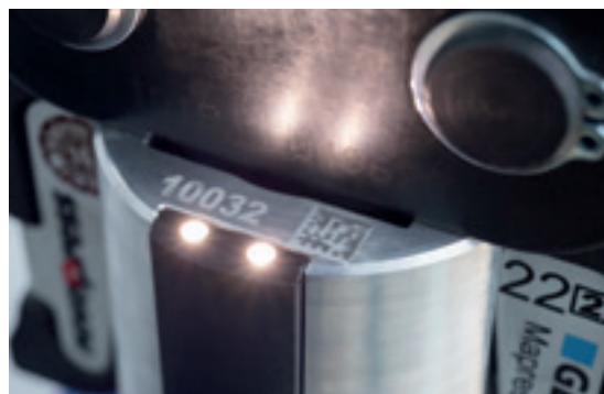
Integrované světlo v nářadí Geberit ACO 103plus, ECO 203 a ACO 203XLplus zaručuje dobrou viditelnost na špatně osvětlených místech.
